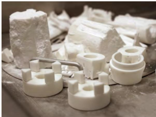
Impression 3D nylon et fibre de carbone
